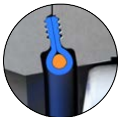
Disco en Posición Abierta. Asiento no comprimido.
